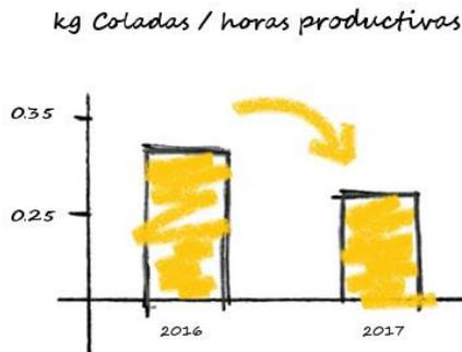
Reducción debida a la optimización del diseño de las coladas en moldes.
