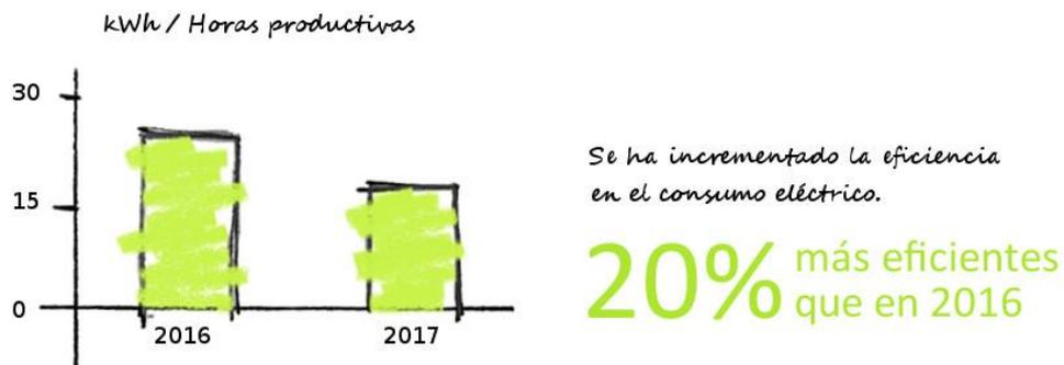
Esta mejora se ha conseguido con actuaciones en las infraestructuras, como el cambio de luminaria LED, y con la renovación y adquisición de máquinas de inyección de mayor eficiencia energética.
